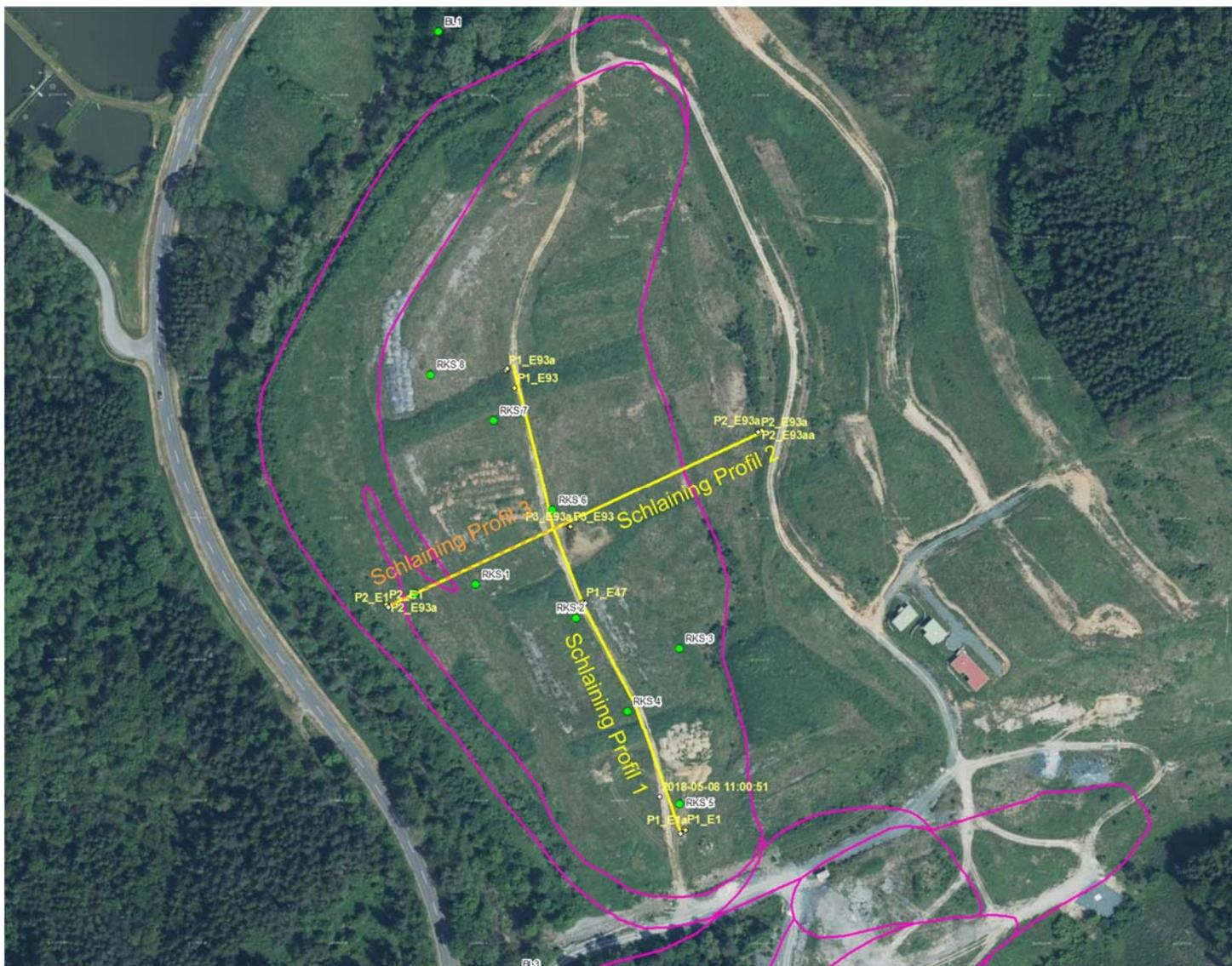
Abb. 56: Lage der geoelektrischen Profile im Messgebiet Schlaining sowie der Bohrungen auf Orthofoto (Quelle: Geoland)
