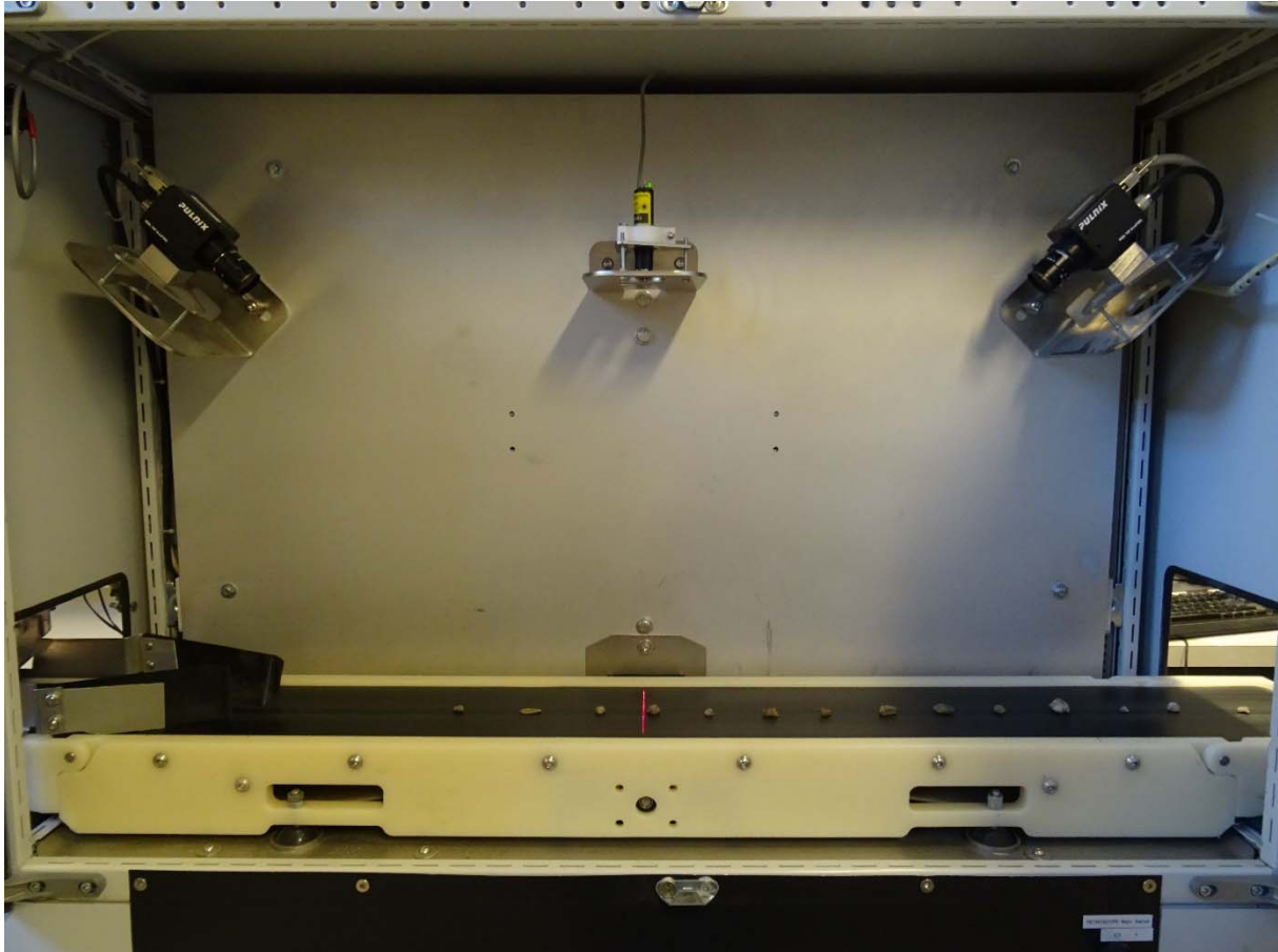
Abb. 12.-2: Aufnahmegeometrie des Petroscope 4D: ein Laser (senkrecht zum Förderband) und zwei optische Kameras tasten jedes Korn ab (Foto: M. Heinrich).
