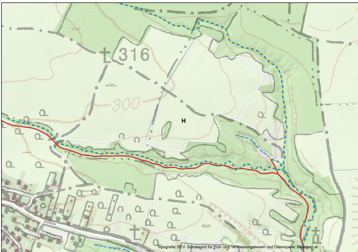
Abb. 11.-1: Vergleich Bachverlauf BEV (rot) mit tatsächlichem, verifiziertem Verlauf aus basemap.at (blau-gelb).
