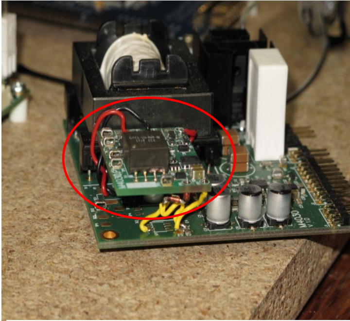
Abb. 2: Neue Platine mit den neuen Transistoren aufgesetzt auf die ursprüngliche Konverter Platine.
