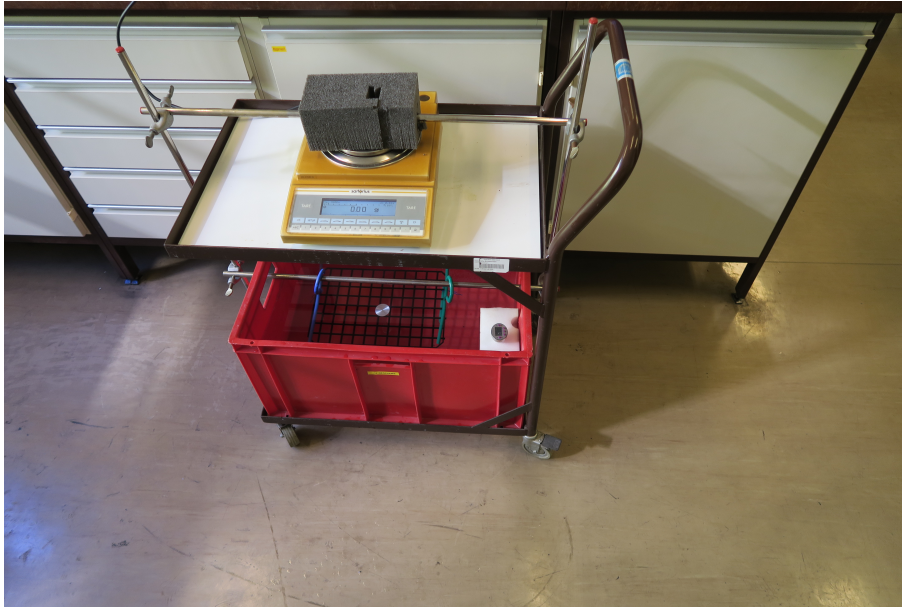
Abbildung 4.1: Apparatur zu Dichtebestimmung. Oben: Waage; Unten: Rotes Becken mit Wasser, darin Käfig zum auflegen der Proben und rechts ein schwimmender Thermometer zur Bestimmung der Wassertemperatur. Die Proben wurden zuerst oben trocken auf der Waage und anschließend unten im Käfig vollständig in Wasser eingetaucht gewogen.
