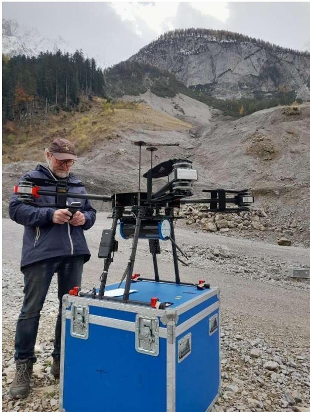
Abbildung 2: Montage des Radiometrie-Sensors MS-700 auf einen Oktokopter
