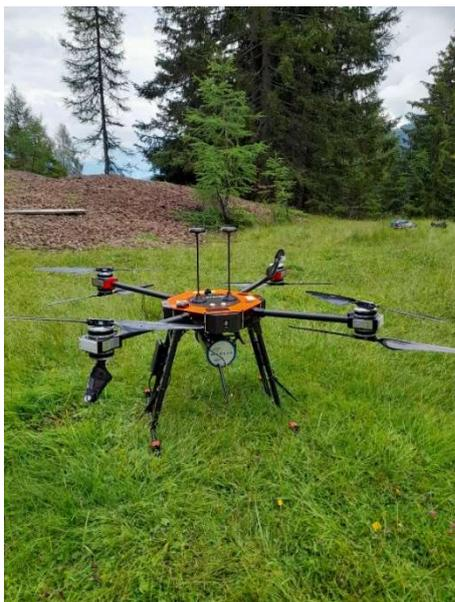
Abbildung 13: einsatzbereite Drohne mit dem befestigten Radiometrie Spektrometer- im Hintergrund die Erzhalde oberhalb welcher der Steigflug durchgeführt wurde.
