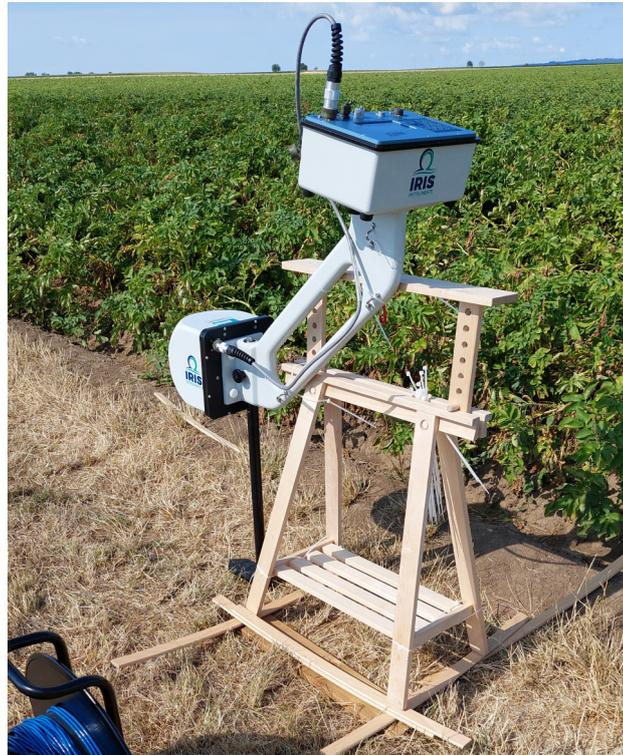
Abbildung 2: Empfängereinheit auf der verwendeten Halterung aus Holz und Kunststoff.
