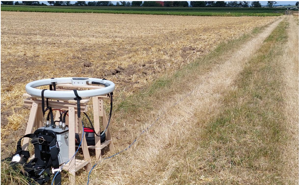
Abbildung 1: Sendeeinheit auf den verwendeten Halterungen aus Holz und Kunststoff. Rechts oben im Bild ist im Hintergrund die Empfängereinheit erkennbar.
