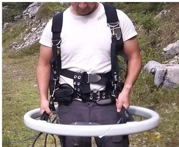
Abbildung 4: Sendespule des PROMIS-Messsystems. Mit Hilfe der Schultergurte getragen.
