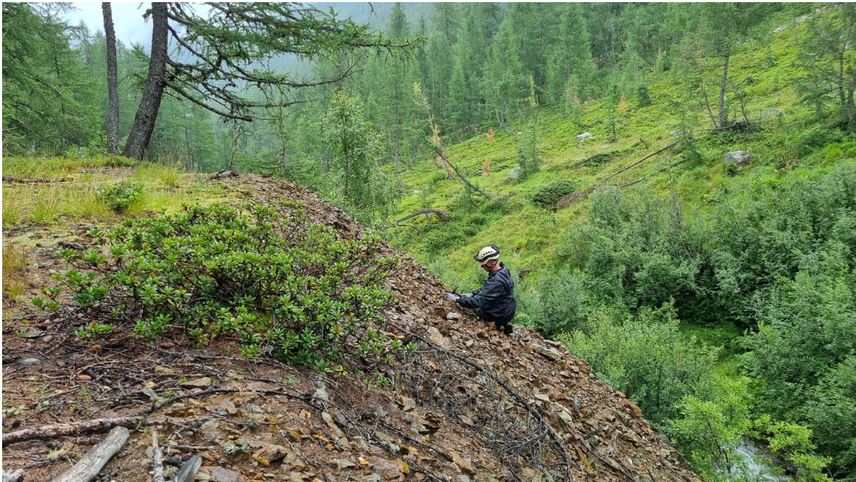
Abbildung 10: Bergbauhalde vor dem befahrenen Stollenmundloch Großfragant. Erze hier sind vor allem Chloritschiefer mit stratiformer Pyrit-Chalcopyrit Impregnation. Untergeordnet sind vererzte Quarzknuern.
