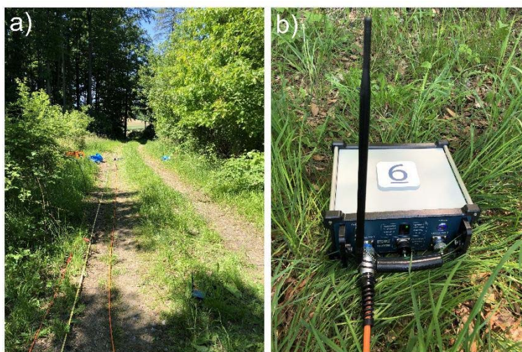
Abb. 2: Fotos der SIP-Messung an Profil 1. (a) Physisch voneinander getrennte Multicore-Kabel wurden abwechselnd mit den Elektroden verbunden. (b) Eine der 6 Boxen, aus denen das Messgerät DAS-M besteht.
