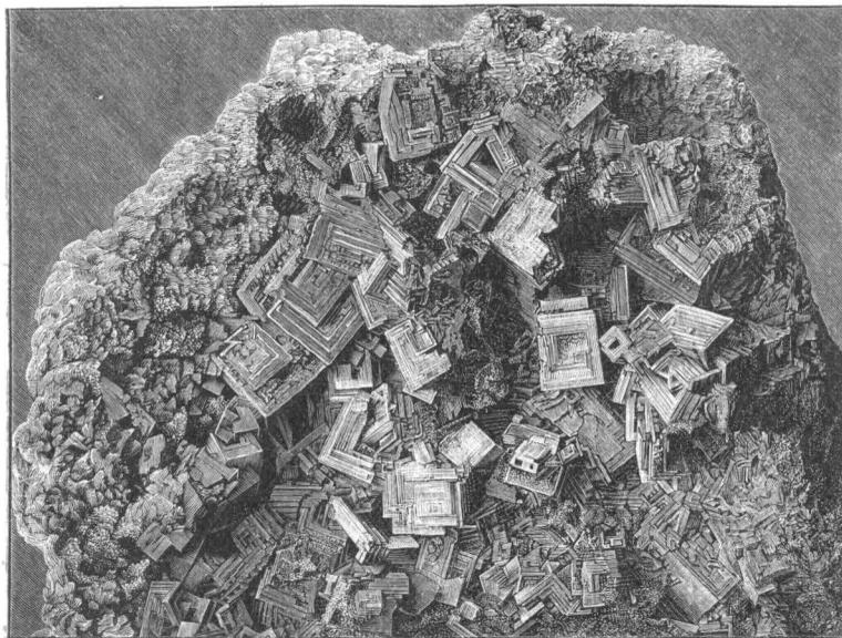
Bleiglanz-Krystalldruse mit unvollständig (skelettartig) ausgebildeten, treppenförmig vertieften Würfeln.
