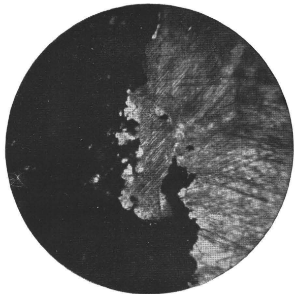
Abb. 9. Dünnschliff in gew. Licht, 12fache Vergr. Erzstufe der Abb.8. Rechts durch Orogenese vorwilligter Kalzit, in welchen von links Bleiglanz idiomorph vordringt.
