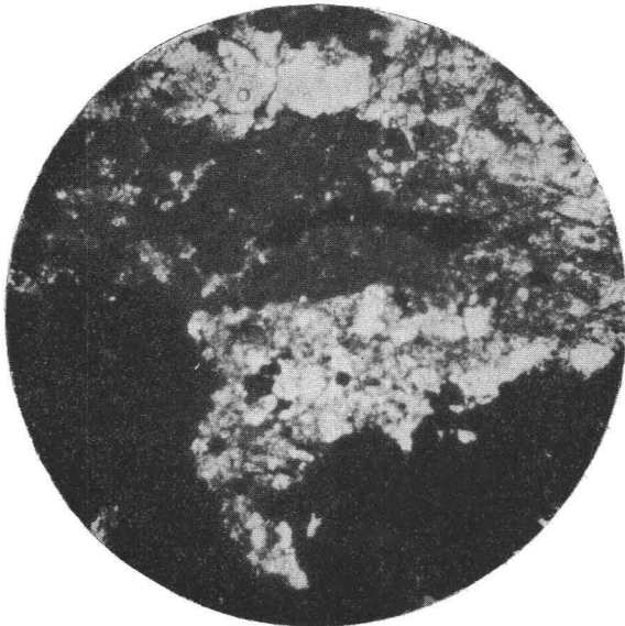
Abb. 3. Dünnschliff einer Blendestufe vom Offberg. Schwarz = Blendepartie mit Quarz (weiß), im Quarz Blende- und Karbonatreste, grau = zerpreßte Karbonatzone, welche eine zerrissene Blendepartie einschließt. Vergr. 1 : 34.
