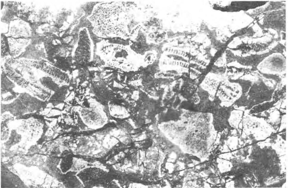
Abb. 46: Wettersteinkalk vom Typus des Algenschuttkalkes vom Sonnwendkogel 6 km W Gröbming, Steiermark. Schliffphoto-Negativ von R. LEIN, Originallänge des Ausschnittes 24 mm.
