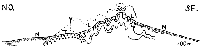
Fig. 5. — COUPE SCHÉMATIQUE A TRAVERS L'EXTRÉMITÉ DU DJEBEL RESSAS. 1/25000. T, Trias; L, Lias et Tithonique non séparés; N, Néocomien. Le point marqué V est l'emplacement du village de la Société minière.
