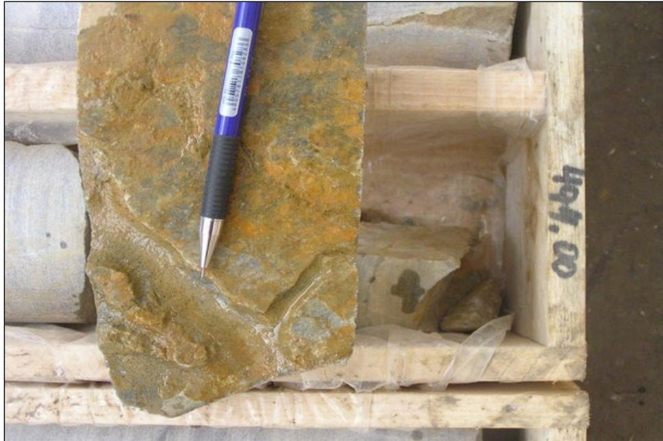
**Abb. 6:** Mikrokarst-Struktur im Hochstegenmarmor, aufgeschlossen in der Bohrung Gr-B-01/04 bei Teufe 494m
