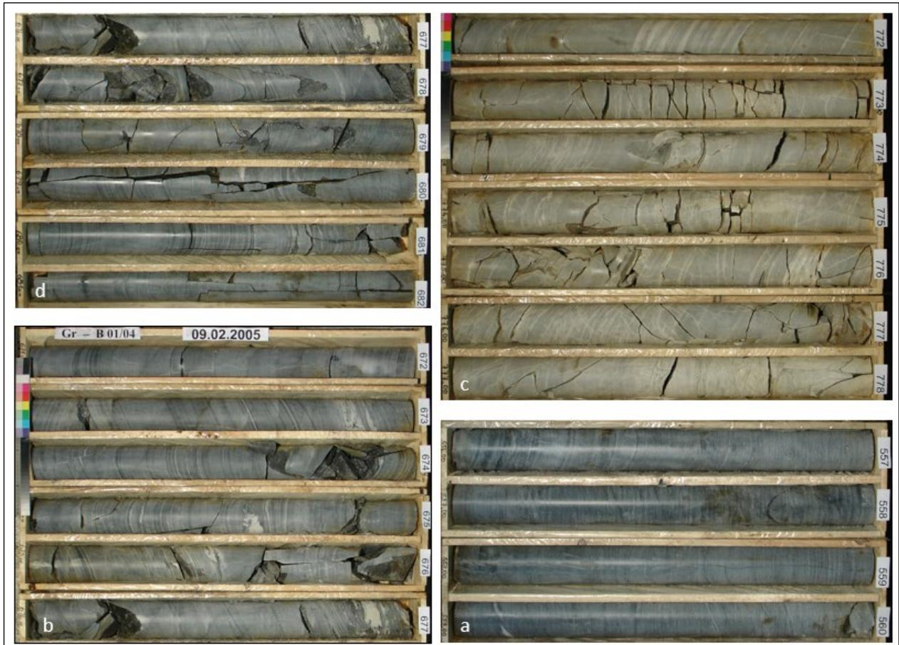
**Abb. 5:** Fototafel von Bohrkernen der Bohrung Gr-B-01/15, Venntal (zunehmender Durchtrennungsgrad von a nach d):
