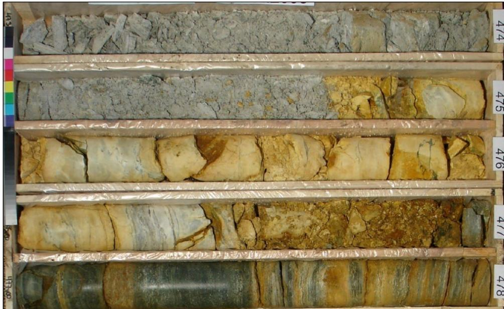
**Abb. 3:** Trias an der Basis der Flatschspitzdecke: Rauhwacke sowie rauhwackoid angelöster Dolomitmarmor (gelb) und Chloritphyllit (grünlich) an der Basis der Triasabfolge in der Bohrung Gr-B-01/04 (473-478m Bohrteufe).
