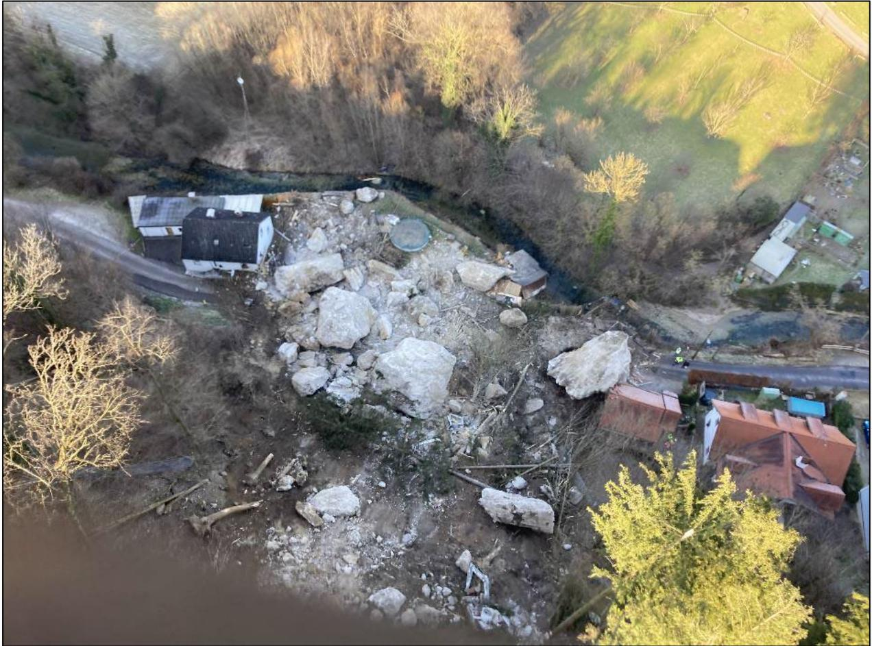
**Abb. 7:** Sturzmasse am Böschungsfuß unmittelbar nach Ereigniseintritt (2023)
