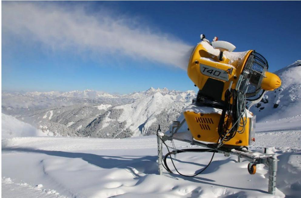
Abb. 4: Eine Propellermaschine („Schneekanone“) bei der Arbeit. Foto: walchhofer.at
