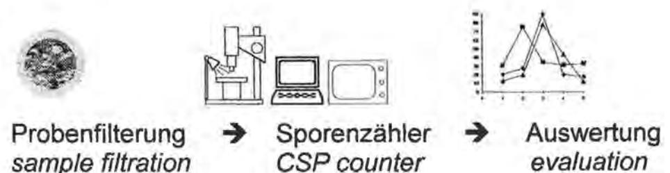
Fig. 9: Schematische Darstellung des Arbeitsablaufes bei automatisierter Sporenzählung (M. DECHANT jr., 1995).
