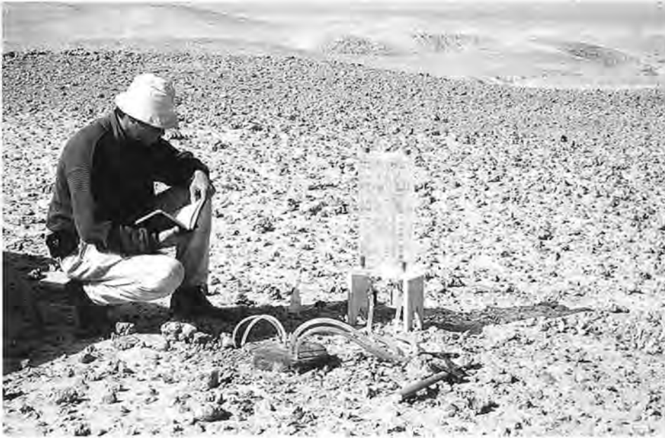
Fig. 5.6: Durchführung von Infiltrationsversuchen mit abgedecktem Doppelring-Infiltrometer. (Foto: H. HÖTZL.)
