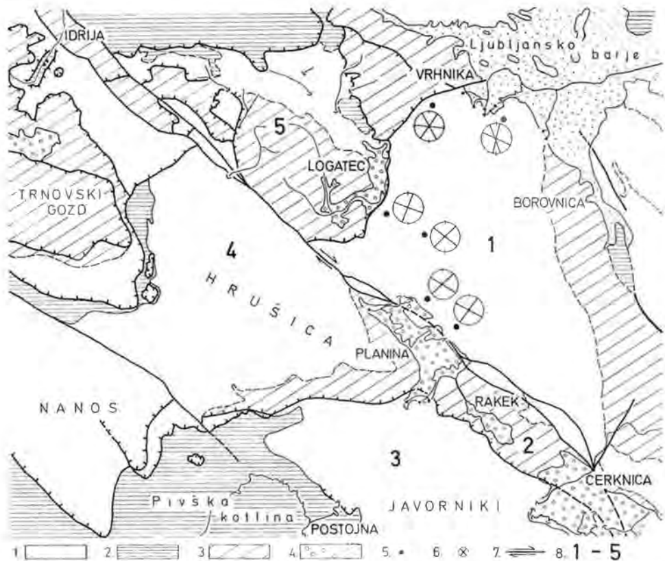
Fig. 6: Hydrogeologische Einheiten im Zentralteil des Einzugsgebietes der Ljubljana. 1 — Kalke, 2 — undurchlässige Gesteine (Schiefer, Mergel usw.), 3 — Dolomite, 4 — Quartärablagerungen in den Karstpoljen und Mooren, 5 — Meßstellen der Rupturen, 6 — Rupturdiagramme, vereinfacht, 7 — Idrija-Verschiebung (=) und andere Verwerfungen, 8 — Hydrogeologische Einheiten; 1 = Vrhniška-Cerkniška-Scholle, 2 = Rakek-Cerkniška-Schuppe, 3 = Javorniki-Snežnik-Scholle, 4 = Hrušica-Scholle, 5 = Idrija-Žiri-Deckenbau (nach S. BUSER, 1965).
