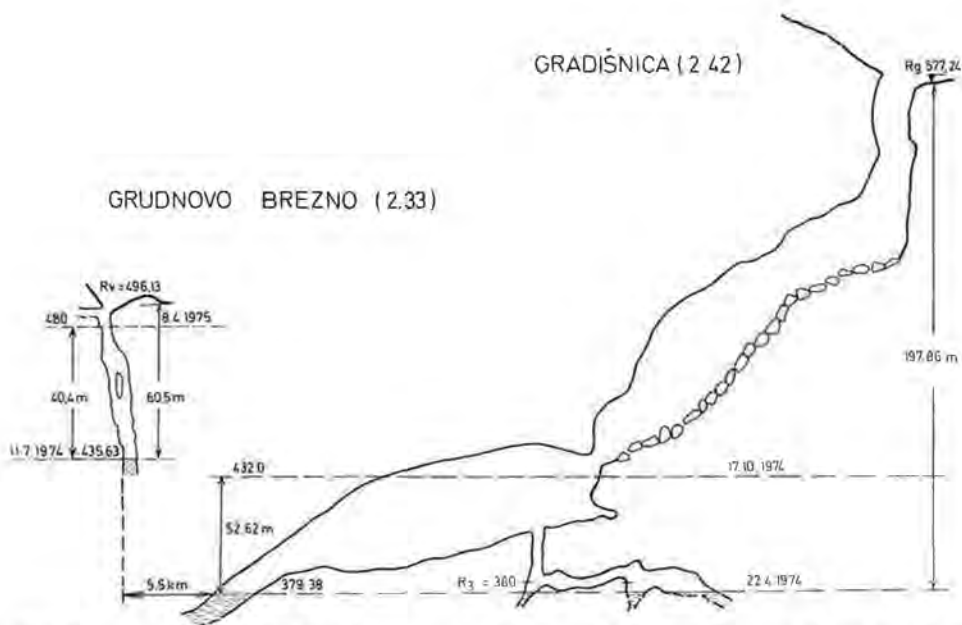
Fig. 16: Aufriß der Schächte Gradišnica (2.42) und Grudnov brezen (2.33) mit dem niedrigsten und mit dem höchsten beobachteten Karstwasserniveau.
