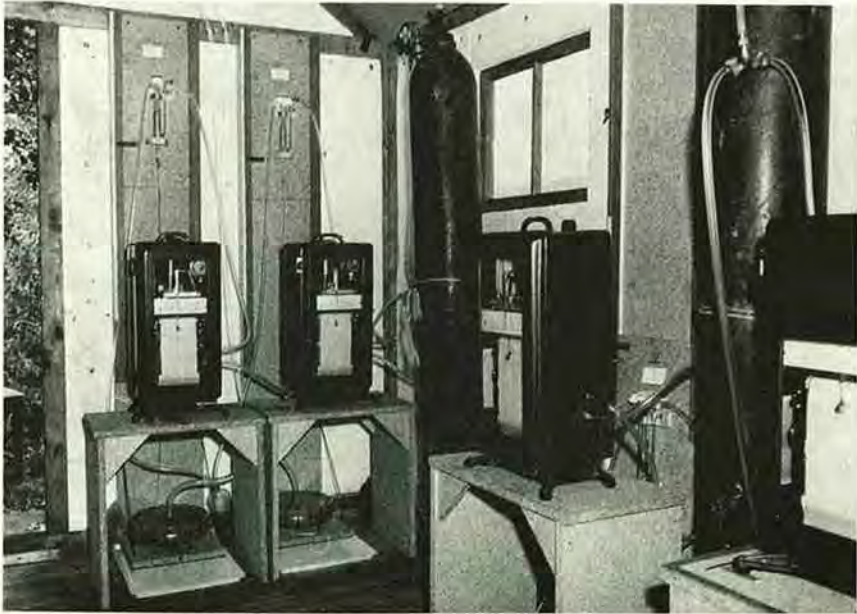
Fig. 2: Station Grafendorf/Oststeiermark. Die automatischen Druckmeßgeräte im Stationshaus registrieren die Druckspiegelschwankungen der einzelnen artesischen Horizonte.
