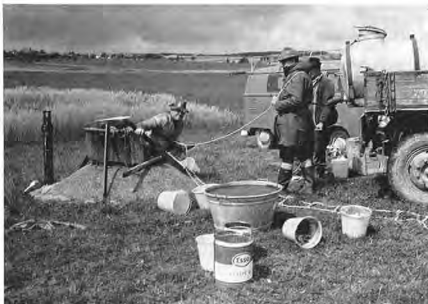
Fig. 69: Eingabestelle I. Hier wurden 28 kg grüngefärbte Lycopodium sporen mit Hilfe eines Feuerwehrschlauches direkt in die offenen Karstspalten am Boden des 12 m tiefen Abwasserschachtes der Gemeinde Neuhausen ob Eck eingebracht. Im Vordergrund der bereits aufgeschlammte Sporenbrei, rechts der Tankwagen für das benötigte Spülwasser. Am Bild ist die sehr ausgeglichene Morphologie der Albhochfläche zu erkennen (Foto: V. MAURIN, 26. August 1969).
