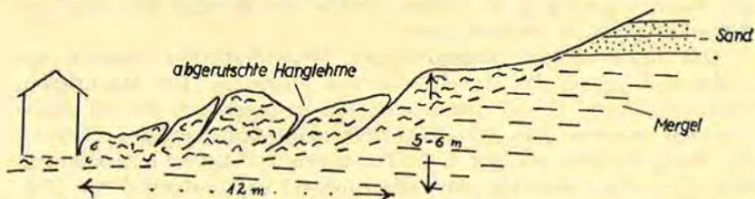
Abb. 4: Rutschung bei Gleichenberg. Die Rutschung wurde durch Entfernung des Hangfues ausgelst.
