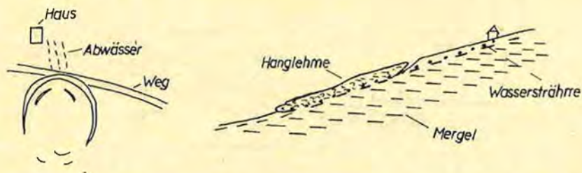
Abb. 1: Rutschungen auf der Konstantinhöhe bei Gleichenberg. Absenkung und Rutschung. Die Abwässer beschleunigen die Rutschung.
