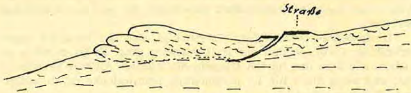
Abb. 7: Ein Damm kommt auf der durchweichten Unterlage zur Setzung und quetscht die anschließenden Hanglehne aus.
