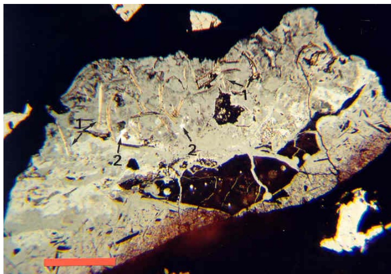
Abb.1.9.15: Glasige Schlackenpartikel (schwarz mit Luftblasen); Graphitlamellen (1) und metall.Eisen (2) in verwitterter Grundmasse (verwittertes Gusseisen?)
