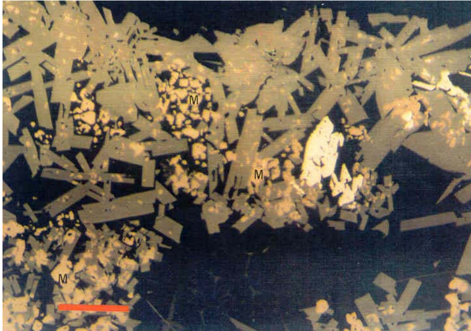
Abb.4: Beispiel für Auflicht-Untersuchung / aus: NEINAVAIE 1994 Idiomorphe Calciumdiferritkristalle (mit Entmischung von Magnetit), Magnetit, Hämatit und Glasphase
