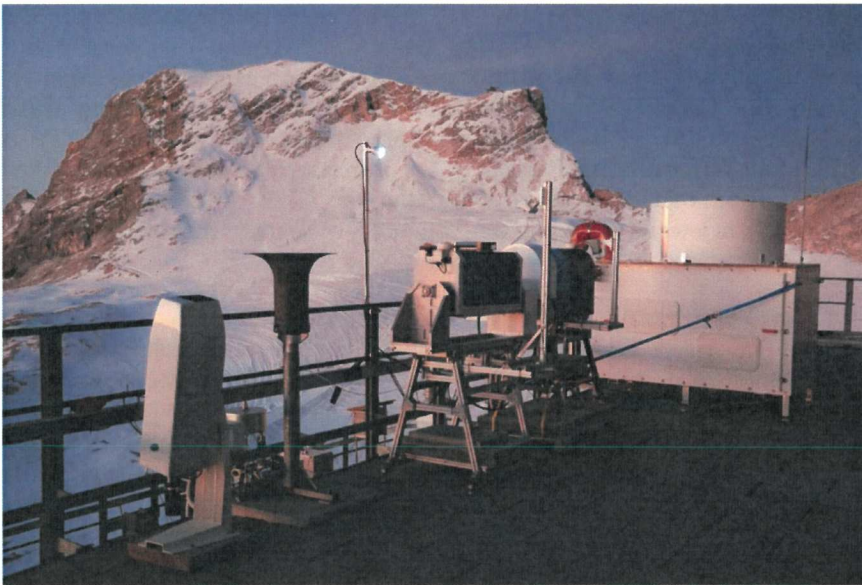
Abbildung 2: Installierte Messinstrumente auf der UFS (von links nach rechts: ein altes LIDAR/Ceilometer ein alter Niederschlagssammler das DPR Mikrowellengerät der Uni Köln zur Bestimmung des Liquid Water Contents das HATPRO Mikrowellengerät der Uni Köln zur Bestimmung des Liquid Water Contents das alte Wolkenradar)
