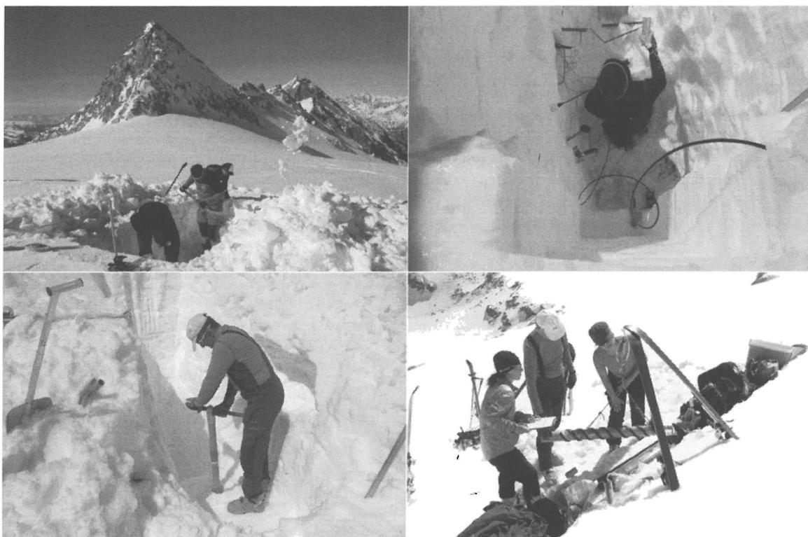
Abbildung 7: Bei den Winterbilanzmessungen am Goldbergkees und am Kleinfleißkees Ende April 2010. An 26 Schneeprofilen wird kontinuierlich Schneedichte, -temperatur und Stratigraphie gemessen. An einzelnen Profilen wird Dielektrizität und Flüssigwassergehalt der einzelnen Schneeschichten gemessen (Fotos: B. Hynek).
