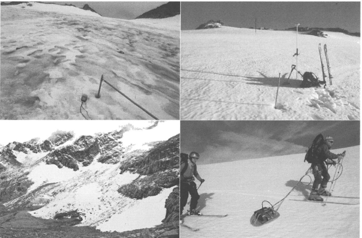
Abbildung 9: Messungen für die Jahresmassenbilanz der Gletscher. An Ablationspegeln wird die Eisabschmelzung gemessen (Resultate siehe Abbildung 10) und mittels RTK-GPS die Bewegung des Eises innerhalb eines Jahres gemessen (siehe Abbildung 11). Rechts unten die Messung der Akkumulation mittels Georadar. Links unten: Die schneebedeckte Zunge des untersten Goldbergkeeses Anfang Oktober 2010 mit zwei markant ausgeprägten Gletschertoren (Fotos: B. Hynek)..
