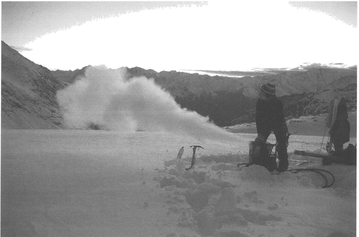
Abbildung 1: (Pegelbohren am Kleinfleißkees, Oktober 2007, (Foto: G. Weyss)
