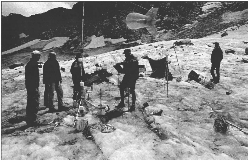
Messkampagne mit Fesselballon und Ultraschallanemometer direkt neben der kontinuierlichen Wetterstation (Mast)
