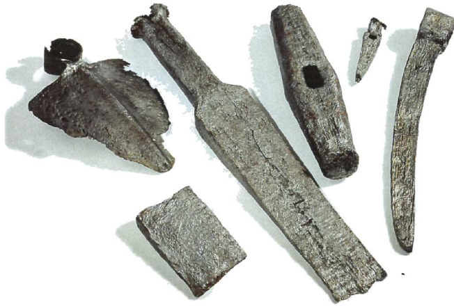
Abbildung 5: Von links nach rechts: Kratze zum Hereinfüllen des Haufwerks in den Fülltrog; kleiner Eisenkeil; großer Eisenkeil; Schlenkerhammer: schwerer Hammer für die Keilarbeit; Berg- oder Stufeisen; Ritzeisen: Gemeinsam mit dem Schlägel als Gezähe beim Stollenvortrieb und Abbau in Verwendung; Keilhaue: Schurfwerkzeug zum Anlegen eines Schurfes (alle Fotos: Landesmuseum Joanneum, N. Lackner, Graz)
