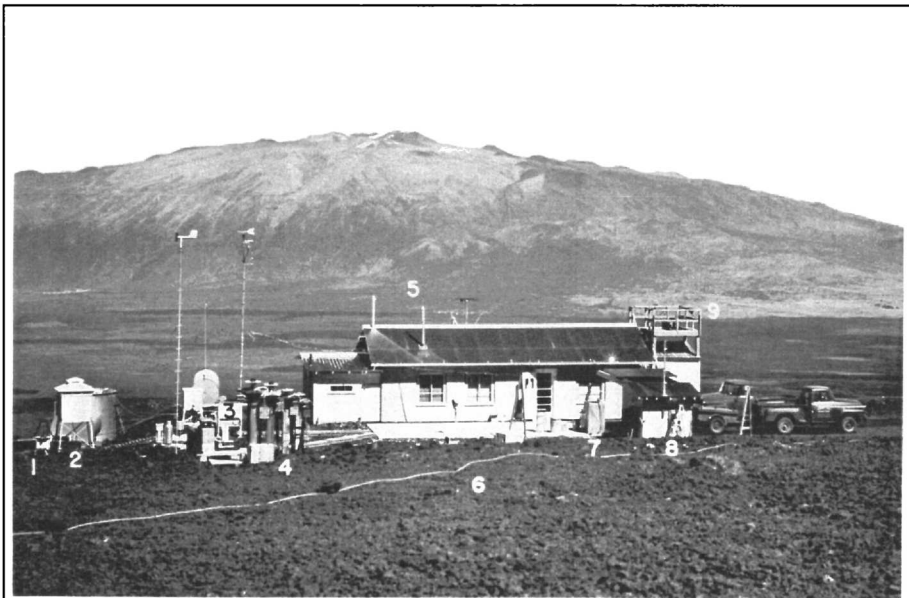
Abb. 2. Nordansicht des Observatoriums am Mauna Loa. Von links nach rechts: Himmelskamera mit 180° Öffnungswinkel (1), Thermometerhütte (2), Infrarot Hygrometer (3), Strahlungsmeßgeräte (4), Ansaugrohr für Ozonmessungen (5), Rohrleitung zur Ansaugstelle für CO 2 -Messungen (6), Gehäuse des Gefrierkernzählers (7), Hütte für das Dobson-Spektrophotometer (8), Beobachtungsplattform (9). Das Sammelgerät für radioaktive Zerfallsprodukte und die Luftelektrizitätshütte sind nicht sichtbar. Im Hintergrund in einer Entfernung von 10 km der Mauna Kea.
