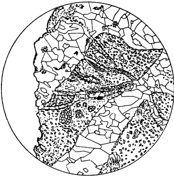
Fig. 2. Der Pfahlquarzit aus dem Schotterbruche auf dem Blätterberge bei Furth i. W. In einem Quarzgeader liegen scharfkantige, feinkörnige Breckienbildungen aus Quarz, Glimmer und Kaolinit. Vergr. 18.
