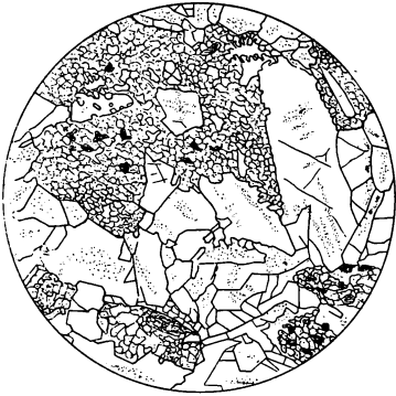
Fig. 9. Ein vollständig verkieseltes Gestein aus dem Schotterbruche bei Schüttwa. Das feine Mosaik der brekzienartigen Bildungen ist fast nur aus Quarz, die Glimmerschüppchen sind selten. Vergr. 58.
