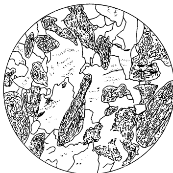
Fig. 8. Der grüne Quarzit aus dem Schotterbruche bei Chodov. In einem Quarzmosaik sind gerundete, keulenförmige und gelappte Partien eines feinschuppigen Glimmers aufbewahrt. Vergr. 50.
