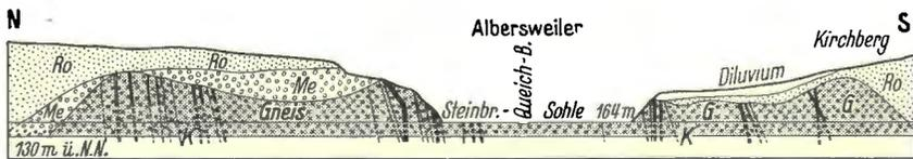
Abb. 53. Profil durch das Queichtal bei Albersweiler in der Pfalz. Nach BORZONG. G = Gneis (injizierte Schiefer); K = Kersentitgänge; Ro = Oberrotliegendes; Me = Melaphyr.
