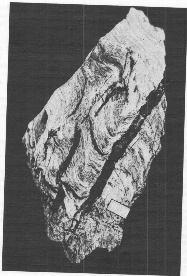
Abb. 2. Tektonische Verformung von »Siderit«-(Pistomesit)-Sericit-Chlorit-Feinschichten durch Fältelung und nachfolgende Rupturenbildung mit Pistomesit-Quarz-Kristallisation. Großanschliff, Marke = 1 cm lang. (Pistomesit: grau bis dunkelgrau, Sericit mit Feinquarz: weißgrau, Quarz: dunkelgrau). Alter Bergbau Lannern-Göbra
