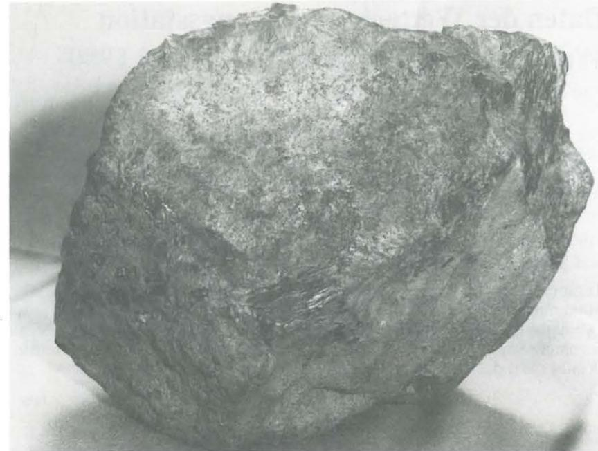
Abb. 3: Hauptstück mit alter Bruchfläche (links unten), frischer Bruchfläche (Zentrum oben) von der Probennahme und zwei deutlich erkennbaren, shatter cone-artigen Harnischen (Bildmitte und rechts oben). Durchmesser der frischen Bruchfläche etwa 22 cm.
