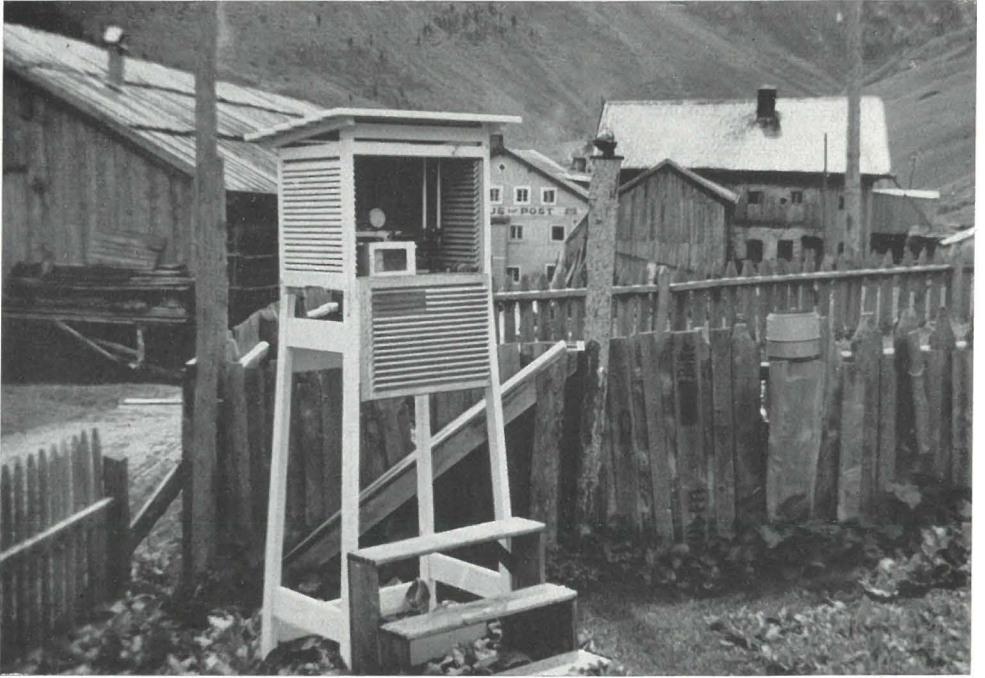
Abb. 1. Meteorologische Station Vent, 1891 m. Taloufenbütte: die — nach Norden — geöffnete Tür gibt den Blick ins Innere mit den Apparaten (Thermos- und Hygrograph, Psychrometer, Haarhygrometer) frei. Der Holzmast zur Linken trägt die Windfahne, der Pfosten zur Rechten den Sonnenscheinauto-graphen (eine versperbare Holzstiege verhindert unbefugten Zutritt); nahe dem rechten Bildrand ragt der Auffangtrichter des Regennessers über den Zaun. (Phot. H. Hoinke)
