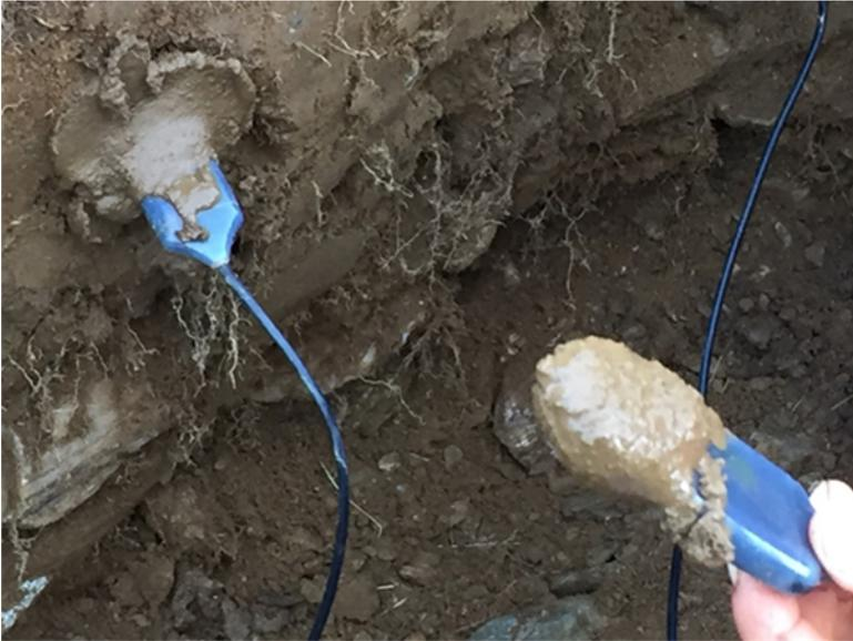
Abbildung 5.11: Einbau der MPS-6-Matrixpotenzial-Sensoren – mit einer Schlämme aus vor Ort gewonnenem Feinboden, Quelle: BFW
