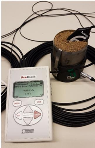
Abbildung 4.4: Versuchsanordnung zur Validierung der Messwerte von Decagon Matrixpotenzialsensoren (MPS-6) mittels HYPROP-System, Quelle: BFW
