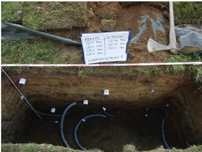
Abbildung 5.10: Anordnung der FDR-HydraProbe Sonden (linke Bildhälfte) und der MPS-6-Sensoren (rechte Bildhälfte) – Standort Landeggalm, Quelle: BFW
