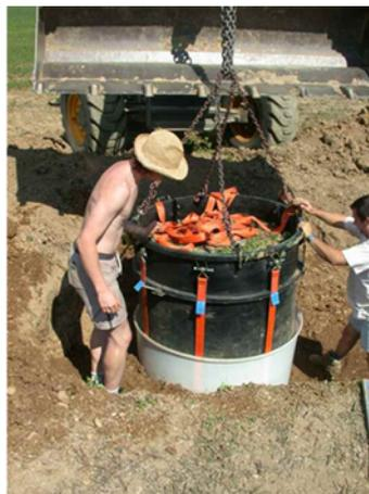
Abbildung 11.16: Ausstechen und Einbau des monolithischen Lysimeter, Quelle: LWK OÖ
