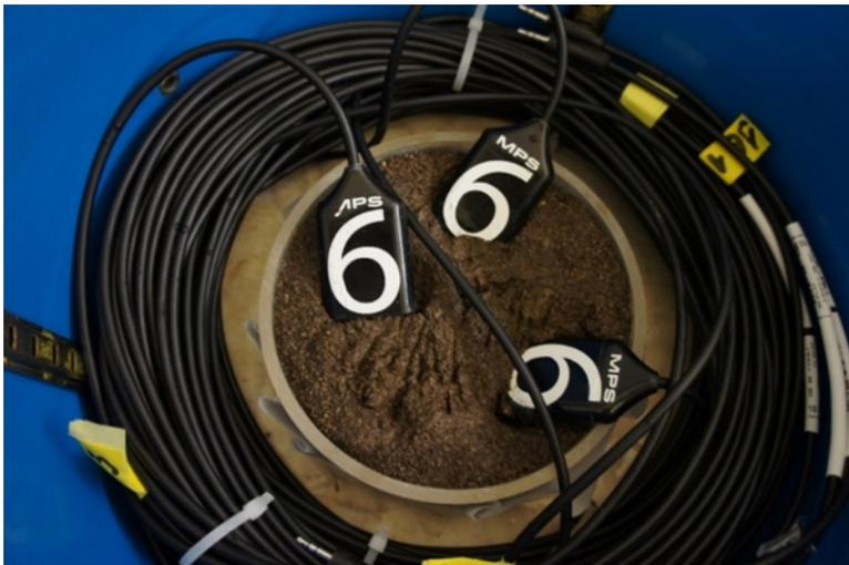
Abbildung 4.3: Einbau von Matrixpotenzialsensoren (Decagon MPS-6) in der Druckplattenapparatur zur Kalibrierung, Quelle: BFW
