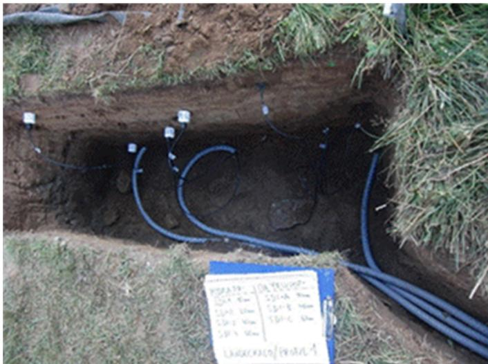
Abbildung 5.7: Beispiel für eine Lageskizze - Anordnung FDR-Profile, MPS-6- und Bodenprofil für die Bodenprobenentnahme (Oberhausalm – Defereggental, Osttirol), Quelle: BFW
