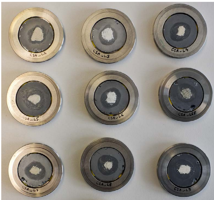
Abb. 11: Präparierte Proben auf Probenträgern; 3.9.2013; Foto: A. Csaplovics
