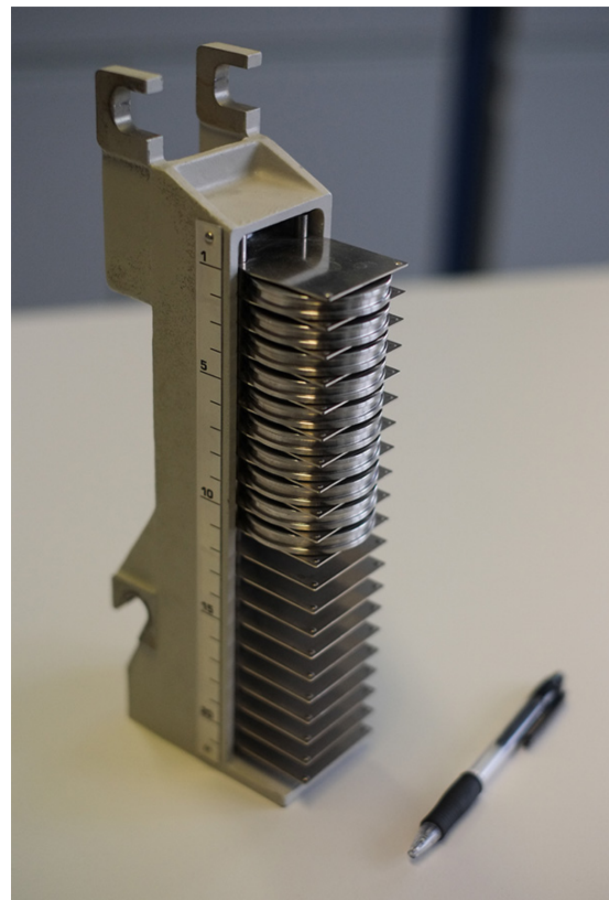
Abb. 10: Probenmagazin des Philips PW3710 Diffraktometers; 3.9.2013; Foto: A. Csaplovics
