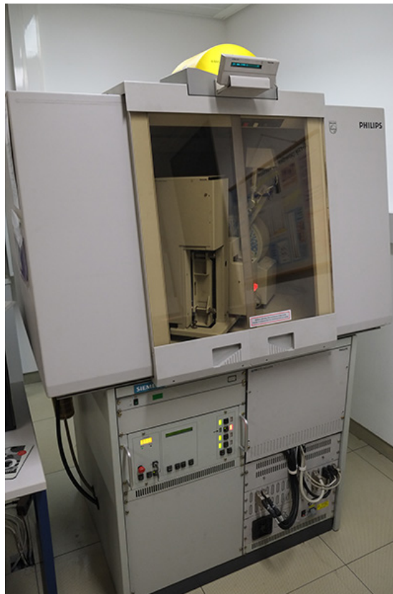
Abb. 12: Das zur Messung verwendete Philips PW3710 ist ein Bragg-Brentano-Diffraktometer mit \theta -2 \theta -Geometrie. Die Röntgenröhre hat als Anodenmaterial Cu; 4.9.2013; Foto: A. Csaplovics
