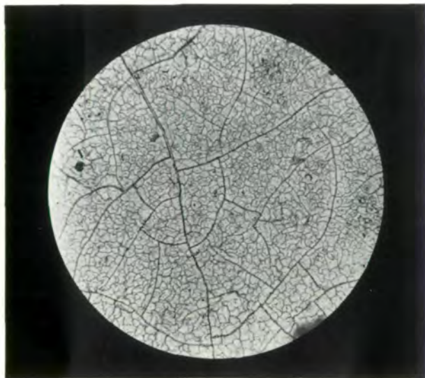
Fig. 2. Bei 1400° entglastes Quarzglas.
