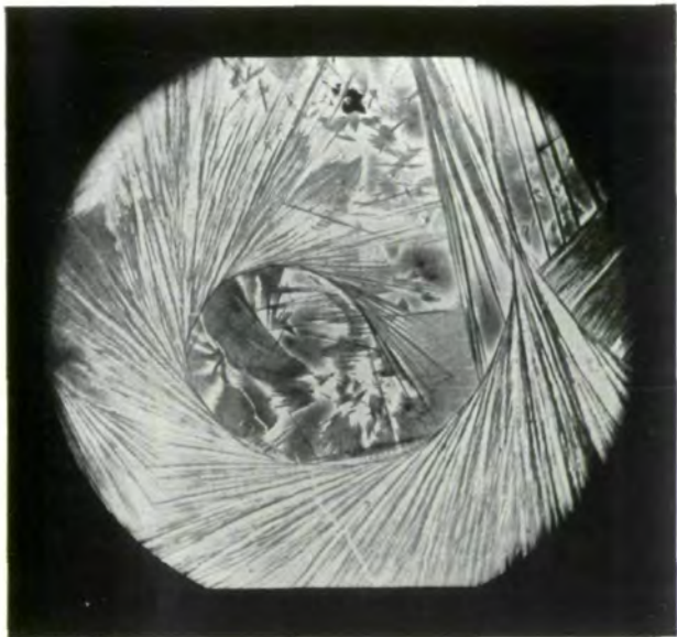
Fig. 3. Titankristallglasur. Mikrophotogramm in 60 facher Vergrößerung.
