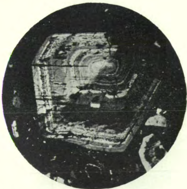
Fig. 6. Kleingefüge von Hornblendeandesit aus Ungarn. Sehr schön zonar gebauter, in Zersetzung befindlicher Feldspat (Plagioklas). Die größtenteils glasige Grundmasse ist auch zersetzt.
