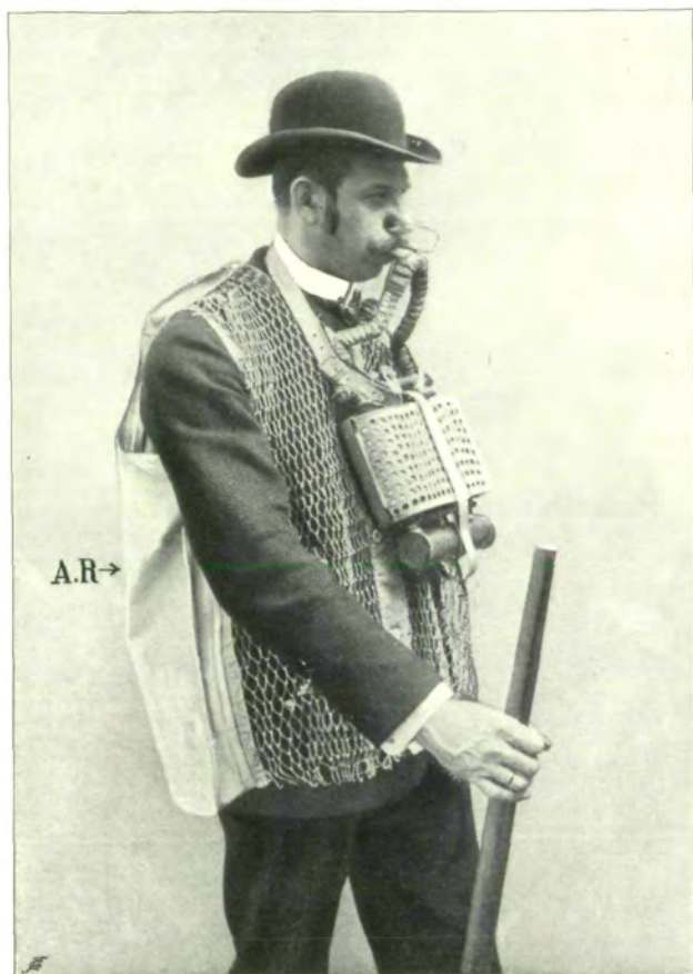
Atmung mit dem „Arbeits“-Apparat (Pneumatogen Type II)
