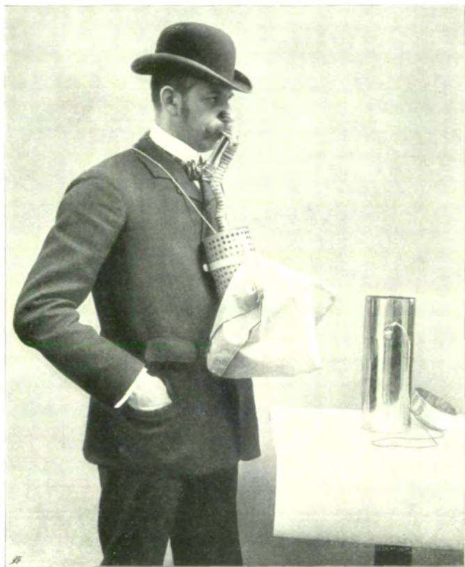
Atmung mit dem Selbststretungsapparat („Pneumatogen“ Type I).
