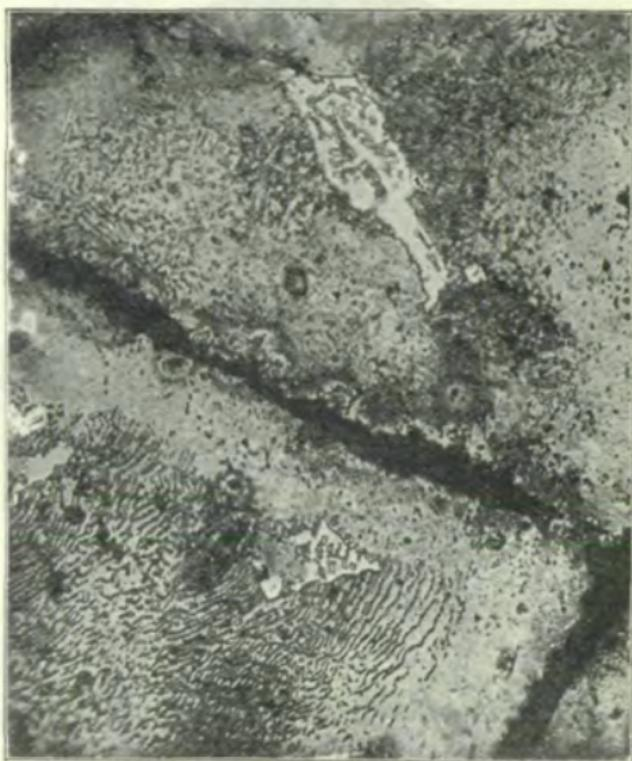
Fig. 8. Graues dichtes Roheisen.  $V = 660$ .
