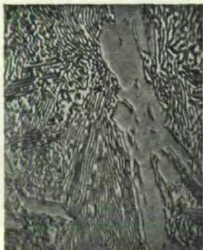
Fig. 6. Stahl (1.50 % C),  $V = 1000$  (Perlit und Zementit).
