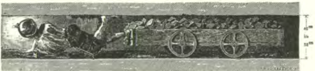
Fig. 4. Beförderung der Erze durch den „Trecker“.
