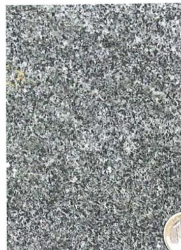
Abb. 192a: Mittelkörniger-Granit, Hartberg bei Schrems, Steinbruch Fa. Poschacher (Foto F. F. Steininger)
