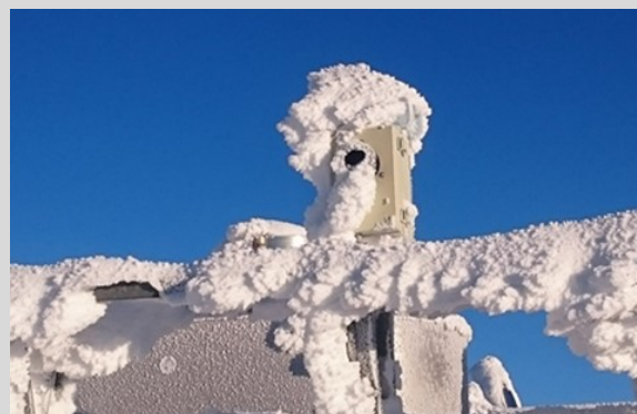
Abb.2: Schwierige Bedingungen für den Ultraschall-Detektor am Sonnblick Observatorium Fig.2: Bad conditions for the ultrasonic-microphone of the „batcorder“
