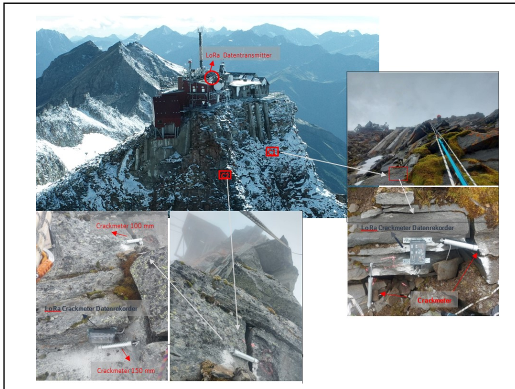
Abb.2: Positionen von Crackmetern in der Nordwand des Sonnblick Observatoriums.
