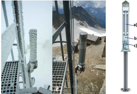
Abb.1: Links: Sonde-Ortsdosisleistung am Sonnblick Observatorium. Rechts: Schema der Sonde mit a) Niederdosiszählrohr, b) Hochdosiszählrohr, c) Auswerteelektronik.
