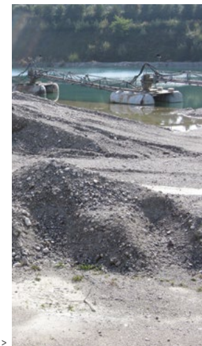
Drau, Schwimmbagger zur Sandgewinnung >
