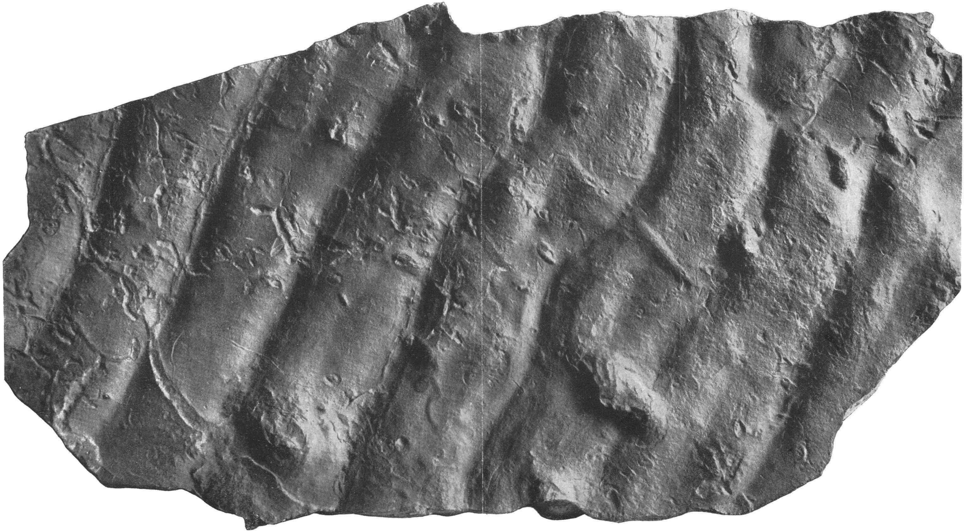
Gipsabguss in halber linearer Verkleinerung. Das Licht fällt von rechts oben ein, so dass die Leeseite der Wellen im Schatten liegt. Die Trockenrisse fallen in die (von links hier gezählten) Furchen 1, 2 und 4; sie sind durch zwei Querrisse verbunden, die eine läuft von Welle 1 oben zur Furche 4 unten, die andere von Furche 2 oben bis Furche 4 (obere Hälfte). Die drei Sandhügel liegen auf Welle 4, 6 und Furche 6.
