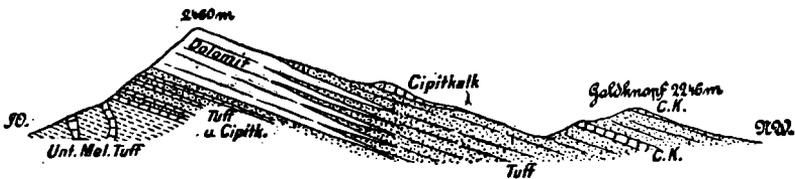
Querschnitt durch das Nordende der Rosszähne, zeigt die Verzahnung des Dolomites im Pachycardientuffe.
