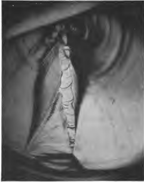
Fig. 15. Sekundäre flammenartige Wellenzüge im muscheligen Bruch von Glas.
