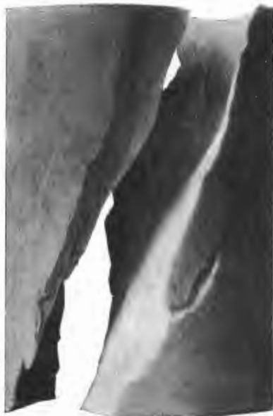
Fig. 2. Marmorzylinder mit einscharig welligem Bruch.
