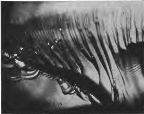
Fig. 19. Gabelung von Riß-Strahlen im muscheligen Bruch von Glas.
