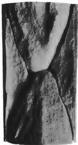
Fig. 3. Marmorzylinder in Richtung seiner Achse gepreßt. Doppelkegeliger Bruchkörper.
