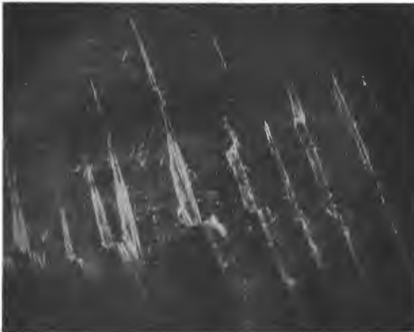
Fig. 18. Bajonettförmig verworfene Strahlen in muscheligem Bruch von Glas.
