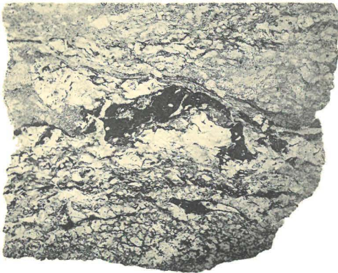
1. Unter starker Pressung zusammengeschweißtes Steinsalz. 2. In gleicher Weise behandelter Sylvin. 3. Dünnschliff eines kieseritischen Sylvinhalits von Schierstedt. Fig. 1 u. 2 etwa natürl. Grösse. Fig. 3 Vergr. 1\frac{1}{2} . F. Rinne: Geothermale Pressungsmetamorphose kieseritischer Sylvinhalite
