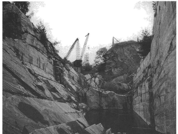
Marmorbruch in Arzwiesen, deutlich erkennbar die durch den Einsatz von Seilsägen entstandenen glatten Schnittflächen.
