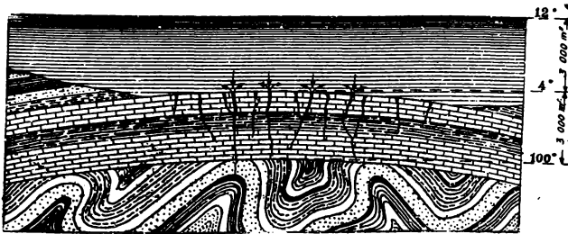
Fig. 5.ª — Génesis de un yacimiento metasomático en posición anticlinal.
